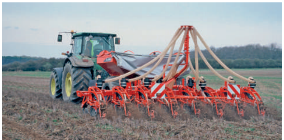
Streifenbearbeitung (Strip-Till) und platzierte Mineral-N-Düngung zu Mais (Reihenweite 75 cm) mit dem achtreihigen Kuhn Striger
