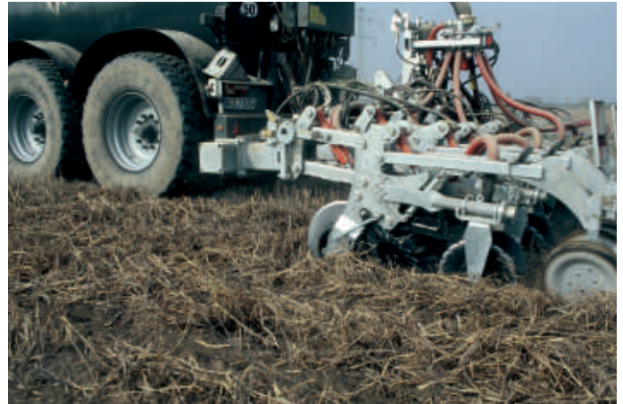
Der achtreihige Vogelsang XTill S arbeitet 20 m 3 Biogasgülle 25 cm tief in abgefrorene Zwischenfrüchte unter
