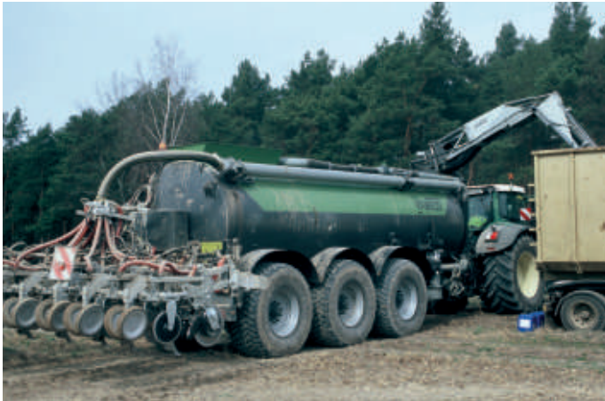
Am Feldrand ist ein Spezialcontainer für die Zwischenlagerung der Biogasgülle aufgestellt. Das Strip-Till-Gerät und Güllefass können auf dem Feld verbleiben und kontinuierlich arbeiten
