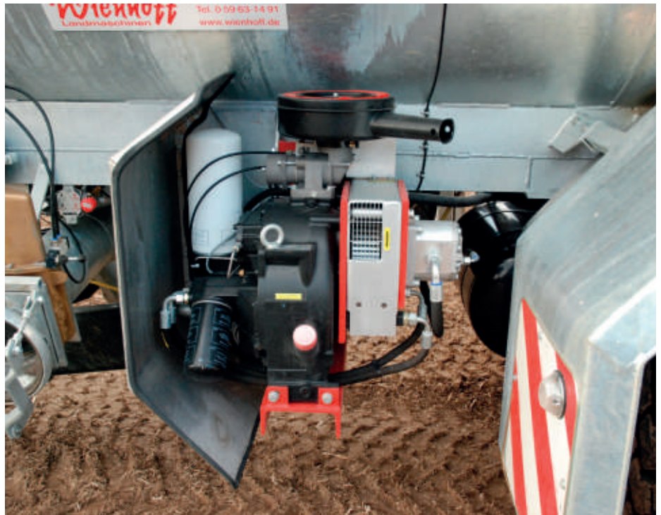
Hydraulisch angetriebener Schraubenverdichter, montiert am Güllefass für das schnelle Aufpumpen der Fass- und Traktorreifen bei der Straßenfahrt zum Güllebehälter
