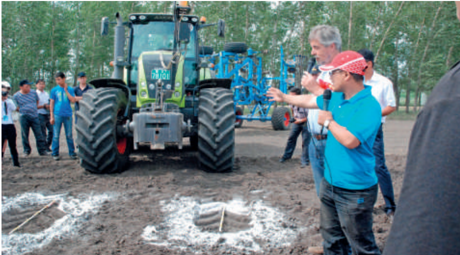
Bei richtigem Reifendruck wird die Traktorlast besser auf größeren Bodenkontaktflächen abgestützt. Links ist 0,6 bar Ackerdruck eingestellt und die Reifen-/Bodenkontaktfläche ist deutlich länger, rechts ist durch 1,6 bar Reifendruck die Kontaktfläche kleiner, die Bodenbelastung und der Schlupf steigen
