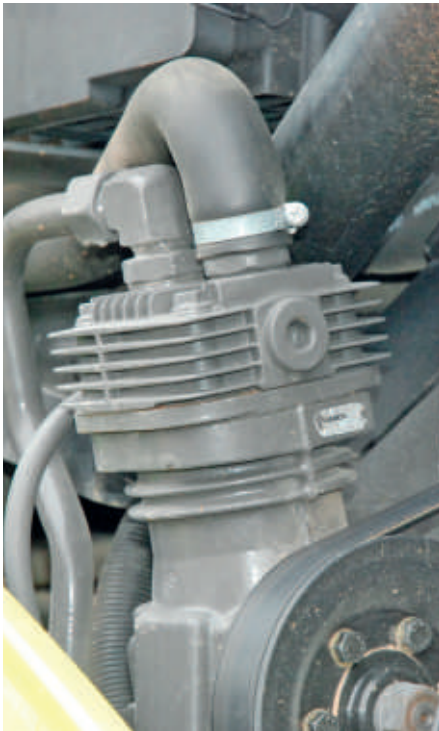
Bremsenkompressor als Druckerzeuger für die Reifendruckregelanlage
