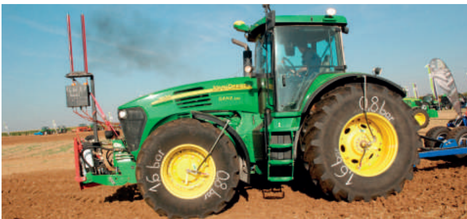
Der gleiche Traktor auf dem gleichen Feld mit dem gleichen Fahrer, dem gleichen Grubber mit gleicher Einstellung und mit empfohlenem Reifendruck von 0,8 bar, anstelle von 1,6 bar Straßendruck, erzielt eine Dieseleinsparung von über 15 Prozent
